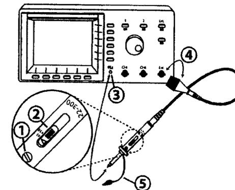
Damit die verwendete Messsignalleitung die Form des Signals unverfälscht wiedergibt, muß es genau an die Eingangsimpedanz des Verstärkers angepaßt werden. Ein im Oszilloskop eingebauter Generator ③ liefert hierzu ein Rechtecksignal mit sehr kurzer Anstiegszeit. Mit dem Messsignalleitung beigegebenen Isolierschraubendreher ist der Trimmer ① wie unten beschrieben abzugleichen.
