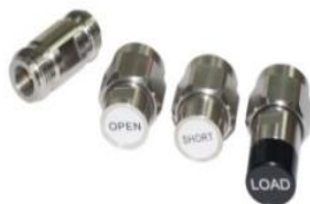
50 \Omega 机械校准件
