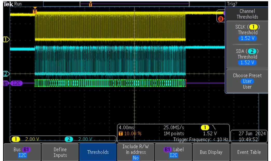
Missing byte decodes on DHO924S
