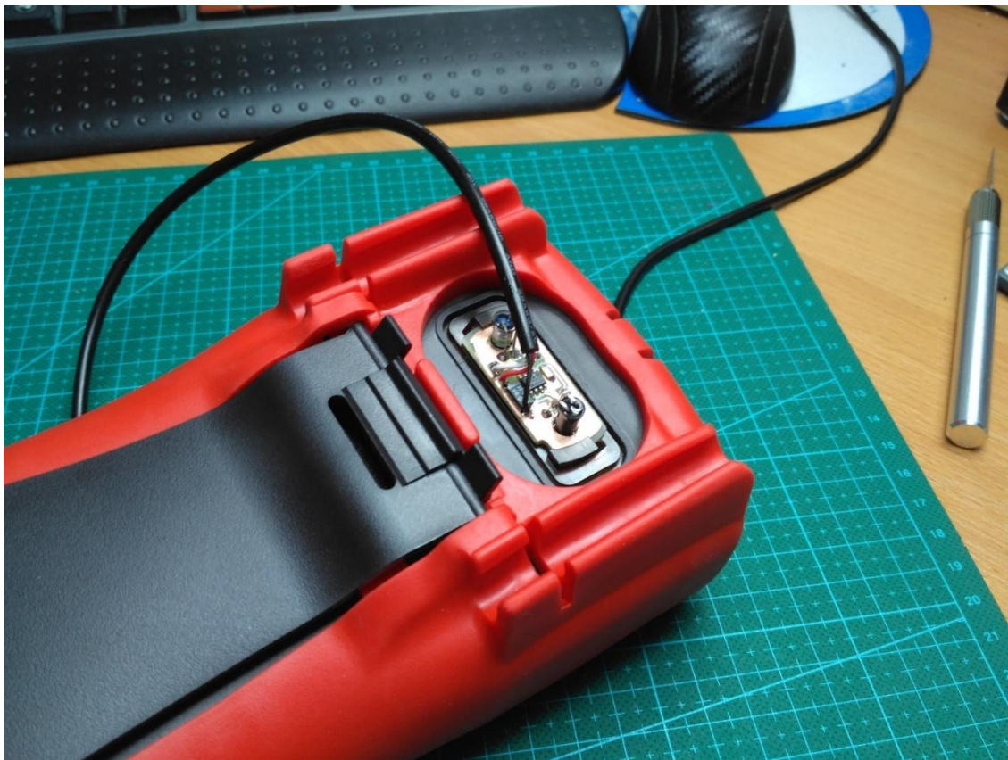
Готовое устройство с на мультиметре с преобразователем USB-UART
