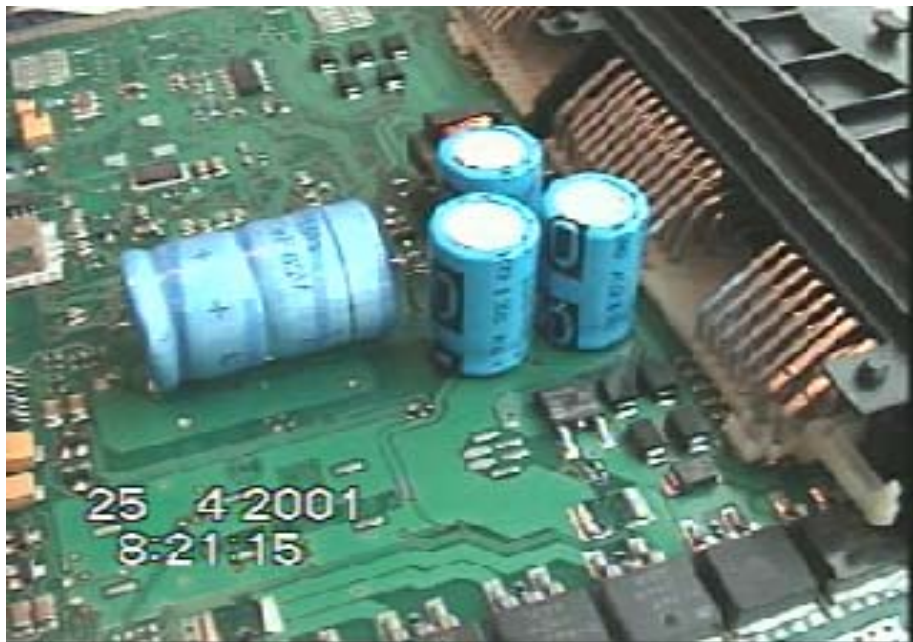
Bild 10 Elektrolytkondensatoren in einer Kfz-Einspritzschaltung von Bosch
